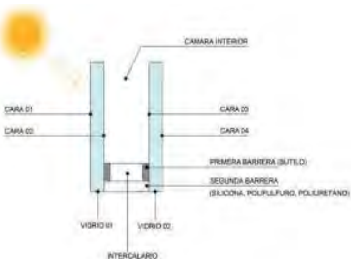
Figura 7. Esquema de un vidrio insulado
