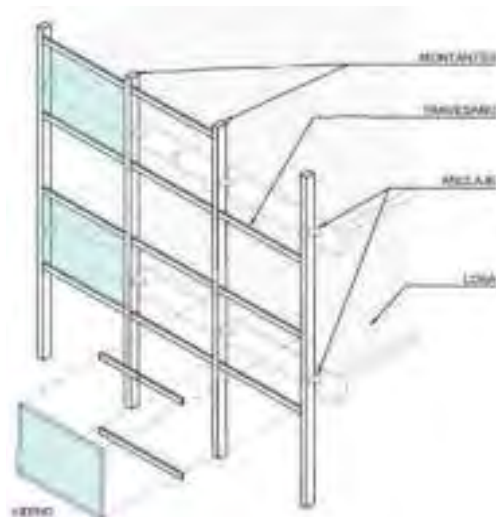
Figura 3. Esquema de fachada con Sistema Stick
